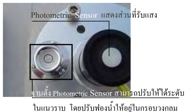
ภาพที่ 67 แสดงการติดตั้งหัวเซนเซอร์ ( Photometric Sensor ) ในการวัดค่าความส่องสว่างพร้อมฐานปรับระดับ โดยการหมุนปรับระดับฟองอากาศให้อยู่ในกรอบวงกลมสีดำ
