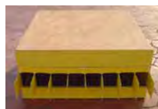
แบบไม่มีอุปกรณ์บังแดด แบบมีอุปกรณ์บังแดดในแนวนอน แบบมีอุปกรณ์บังแดดในแนวตั้ง ภาพที่ 56 แสดงหุ่นจำลองที่มีลักษณะช่องแสงแบบที่ 1 กับรูปแบบอุปกรณ์บังแดดแบบต่างๆ
