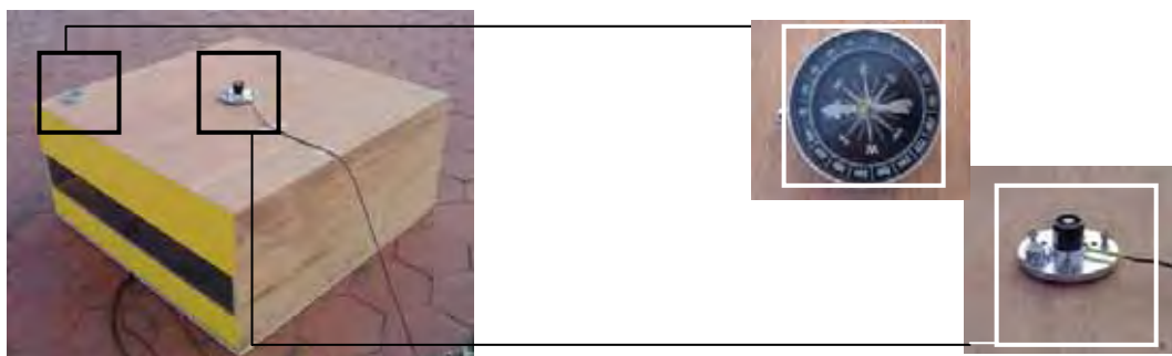
ภาพที่ 75 แสดงตำแหน่ง Photometric Sensor ที่วัดค่าความส่องสว่างภายนอกหุ่นจำลอง และการใช้เข็มทิศในการวางตำแหน่งทิศทางของหุ่นจำลองให้ถูกต้อง
