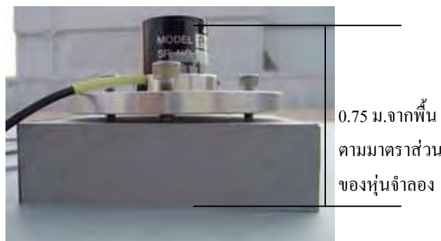
ภาพที่ 74 แสดงฐานตั้ง Photometric Sensor ให้ได้ระดับความสูงรวม 0.75 เมตรจากพื้น ตามมาตราส่วนของหุ่นจำลอง
