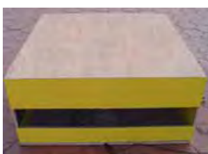
แบบไม่มีอุปกรณ์บังแดด แบบมีอุปกรณ์บังแดดในแนวนอน แบบมีอุปกรณ์บังแดดในแนวตั้ง ภาพที่ 56 แสดงหุ่นจำลองที่มีลักษณะช่องแสงแบบที่ 1 กับรูปแบบอุปกรณ์บังแดดแบบต่างๆ
