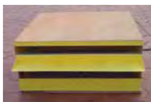
แบบไม่มีอุปกรณ์บังแดด แบบมีอุปกรณ์บังแดดในแนวนอน แบบมีอุปกรณ์บังแดดในแนวตั้ง ภาพที่ 57 แสดงหุ่นจำลองที่มีลักษณะช่องแสงแบบที่ 4 กับรูปแบบอุปกรณ์บังแดดแบบต่างๆ
