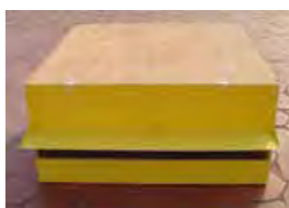
แบบไม่มีอุปกรณ์บังแดด แบบมีอุปกรณ์บังแดดในแนวนอน แบบมีอุปกรณ์บังแดดในแนวตั้ง ภาพที่ 56 แสดงหุ่นจำลองที่มีลักษณะช่องแสงแบบที่ 1 กับรูปแบบอุปกรณ์บังแดดแบบต่างๆ
