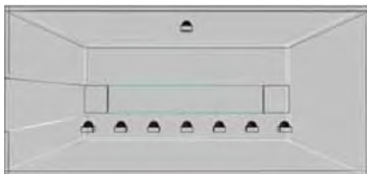
ภาพที่ 80 แสดงตำแหน่งของ Sensor ที่ใช้ในการวัดค่าความส่องสว่างภายในห้องเรียนจำลอง ณ ตำแหน่งกึ่งกลางห้องเรียน
