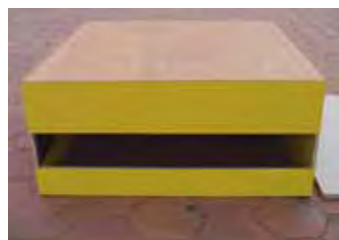
ภาพที่ 55 แสดงส่วนพื้นแยกส่วนกับส่วนผนังและเพดานเพื่อสามารถปรับเปลี่ยนหุ่นจำลองที่มีลักษณะช่องแสงทั้ง 2 แบบโดยไม่ต้องทำส่วนพื้นเพิ่ม และสะดวกในการติดตั้งเซนเซอร์วัดแสง ( Sensor )
