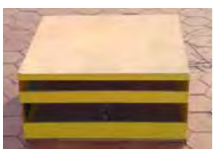
แบบไม่มีอุปกรณ์บังแดด แบบมีอุปกรณ์บังแดดในแนวนอน แบบมีอุปกรณ์บังแดดในแนวตั้ง ภาพที่ 57 แสดงหุ่นจำลองที่มีลักษณะช่องแสงแบบที่ 4 กับรูปแบบอุปกรณ์บังแดดแบบต่างๆ
