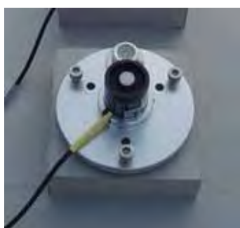
ภาพที่ 67 แสดงการติดตั้งหัวเซนเซอร์ ( Photometric Sensor ) ในการวัดค่าความส่องสว่างพร้อมฐานปรับระดับ โดยการหมุนปรับระดับฟองอากาศให้อยู่ในกรอบวงกลมสีดำ
