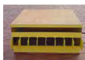
แบบไม่มีอุปกรณ์บังแดด แบบมีอุปกรณ์บังแดดในแนวนอน แบบมีอุปกรณ์บังแดดในแนวตั้ง ภาพที่ 57 แสดงหุ่นจำลองที่มีลักษณะช่องแสงแบบที่ 4 กับรูปแบบอุปกรณ์บังแดดแบบต่างๆ
