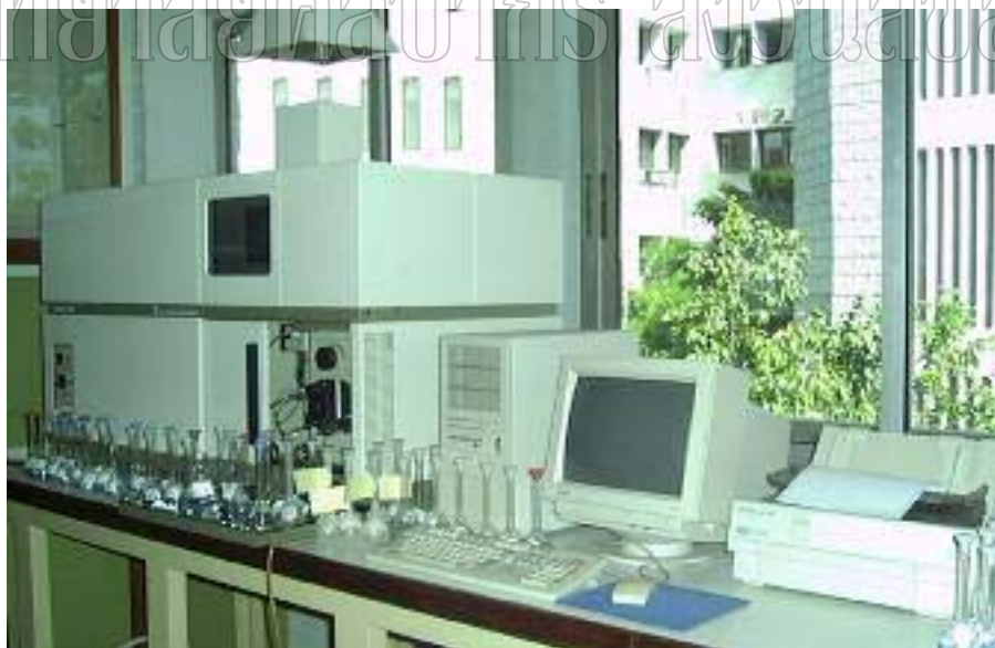
รูปที่ 1.16 เครื่อง Inductively Coupled Plasma Spectrometer (ICPS) Varian Liberty 220
