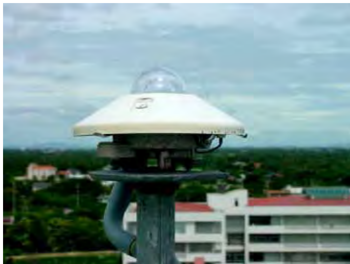
รูปที่ 3.50 แสดงเครื่องไพราโนมิเตอร์สำหรับวัดความเข้มรังสีรวมของดวงอาทิตย์ ของสถานีนครปฐม
