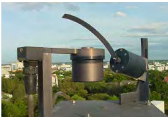
รูปที่ 2.12 เครื่อง Multi-filter rotating shadow band radiometer (MFR-7)
