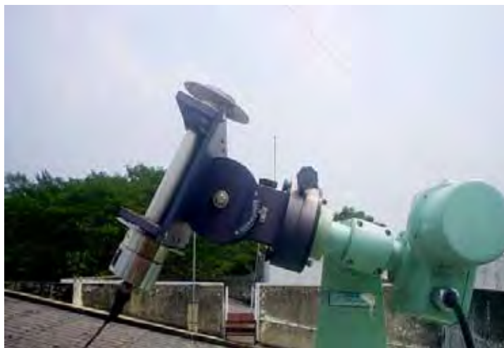
รูปที่ 3.54 แสดงเครื่องไพเฮริโอมิเตอร์สำหรับวัดความเข้มรังสีรวมของดวงอาทิตย์ ของสถานีสถาบันเทคโนโลยีแห่งเอเชีย จังหวัดปทุมธานี
