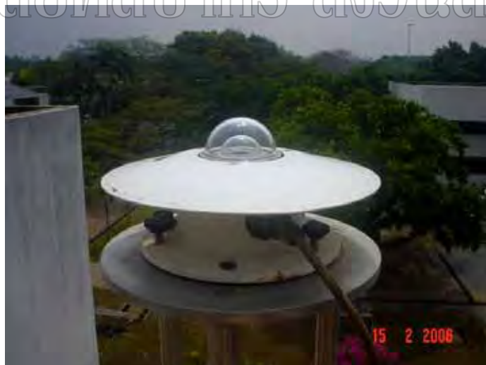
รูปที่ 3.49 แสดงเครื่องไพราโนมิเตอร์สำหรับวัดความเข้มรังสีรวมของดวงอาทิตย์ ของสถานี AIT
