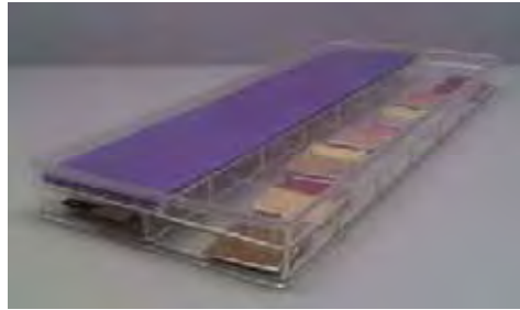
รูปที่ 4.16 ชุดทดสอบความคงทนของสีต่อแสง ในรูปแบบ Light fastness test kit
