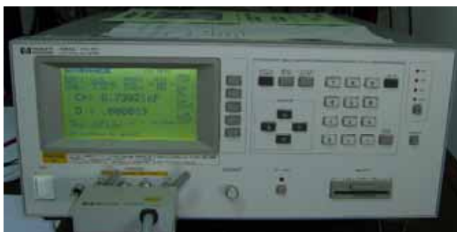
รูปที่ 4.11 เครื่อง LCR Meter ของบริษัท HEWLETT PACKARD รุ่น 4284A
