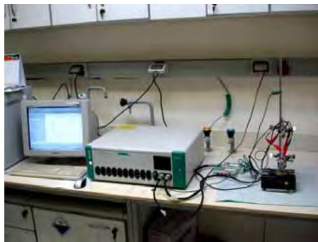
ภาพที่ 27 การต่อขัวอิเลคโทรดทั้ง 3 ชนิด เข้ากับเครื่องควบคุมกระแสไฟฟ้า
